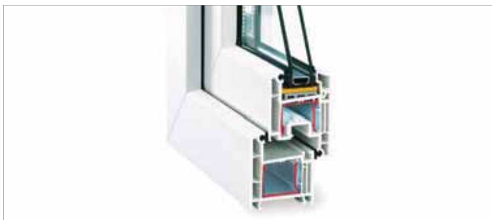
Внутренняя камера для стального армирования размером 35 мм заботится о долгосрочной прочности оконного блока.
